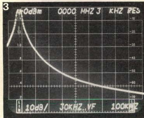
Figuur 3. Verloop van de demping bij een symmetrische meting met een bron- en een uitgangsimpedantie van 60 \Omega .
